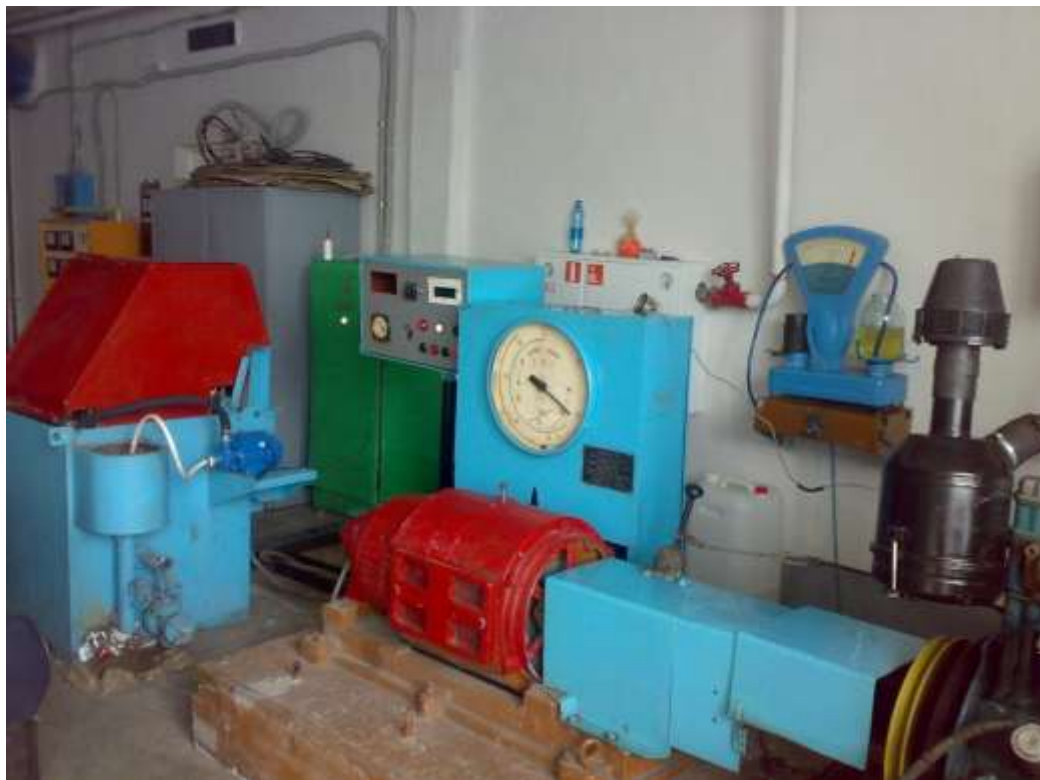
Фото 1. Стенд обкаточно-тормозной КИ-5543 ГОСНИТИ
